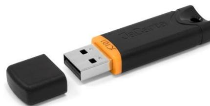
**Для защиты разъёма USB** от попадания пыли, влаги, мелких твёрдых частиц служит съёмный пластиковый колпачок, входящий в комплект поставки.
