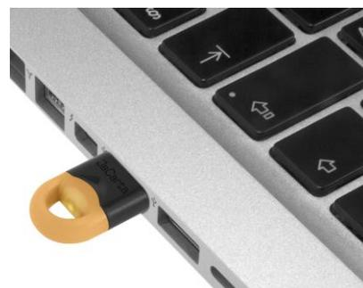
Привычный металлический USB-разъём заменён на пластиковый, являющийся продолжением корпуса токена.
